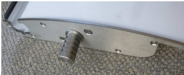
Lamellenansicht, Lagerseite (Abb. 7).
